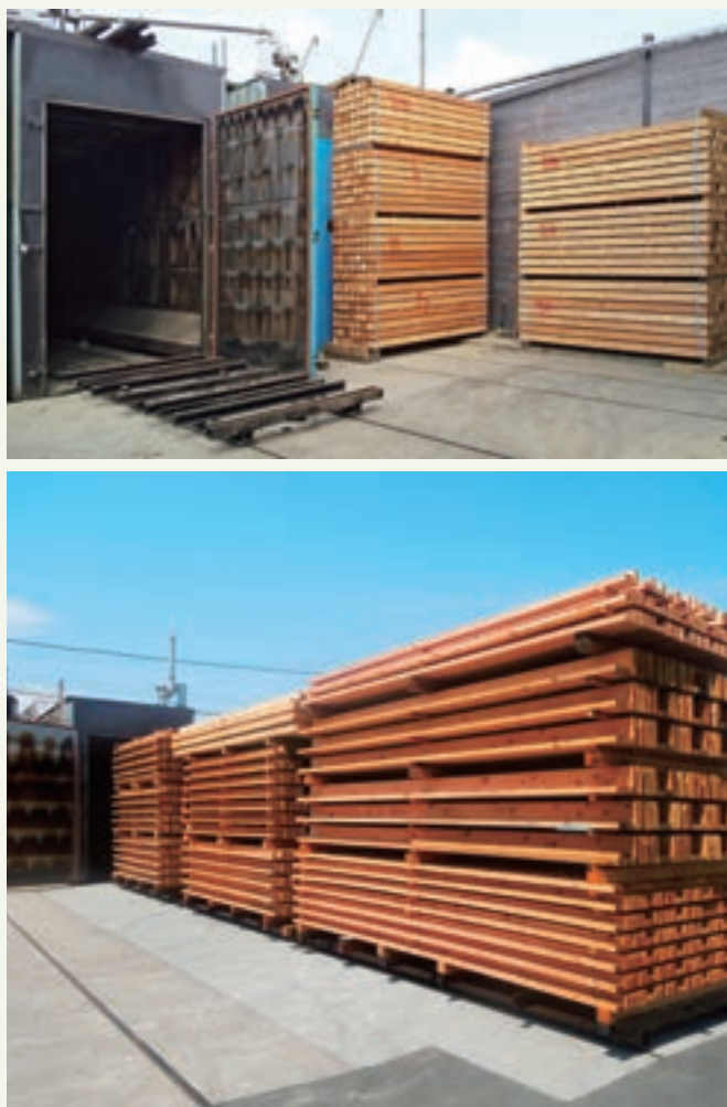
▼写真2 蒸気式乾燥装置
