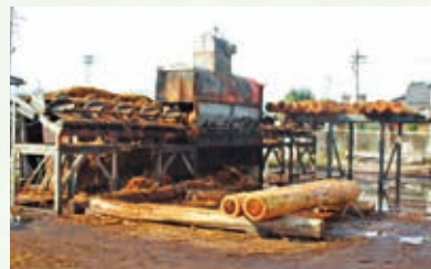
最近では少なくなった水圧バーカーで皮剥を行っています。
