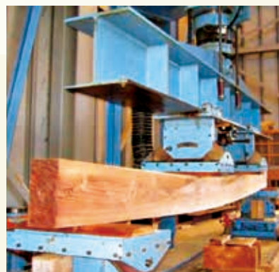
平角材の曲げ強度試験
